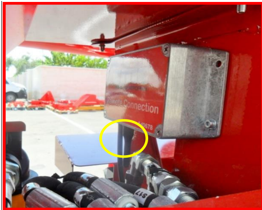
Figure 94 : Boîtier de connexion à distance.
