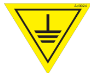
Figure 84 : mise à la terre.
