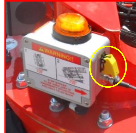
Figure 24 : bouton de by-pass de blocage de translation.
